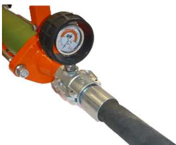
Рис. 18: Манометр давления раствора
