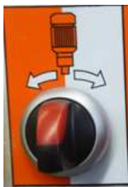
Рис. 14: Режимы эксплуатации привода насоса
